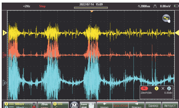
Рис. 3. Осциллограмма факельного разряда (ток, напряжение)
