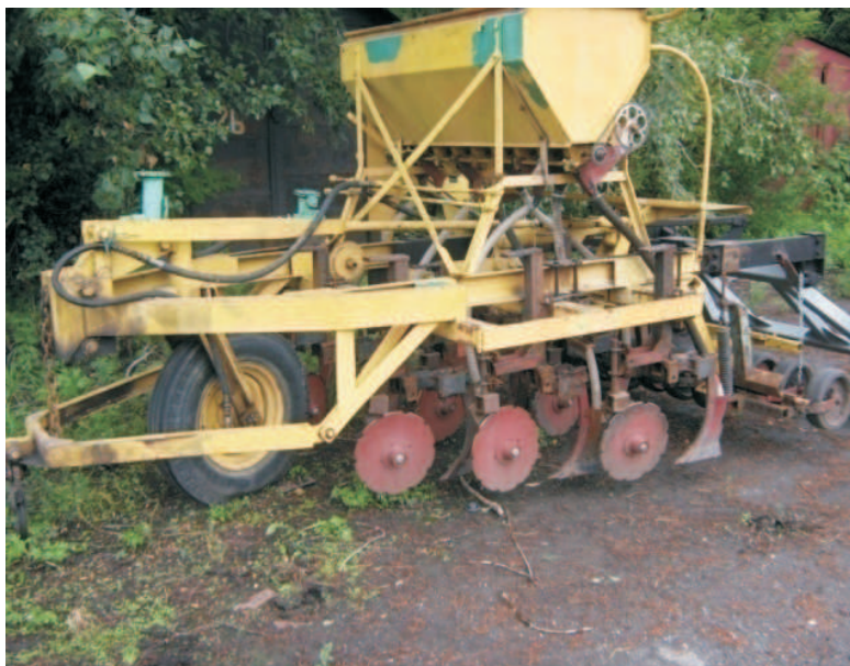
Рис. 3. Экспериментальный образец технического средства с дисково-анкерными сошниками с острым углом вхождения в почву с разнесенными структурными элементами
