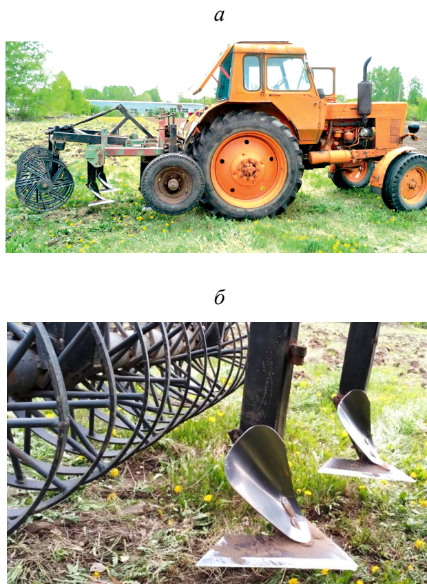
Рис. 1. Трактор МТЗ-80Л с почвообрабатывающим агрегатом АКП-2,5Н (а) и стойка, оснащенная отвалом (б)
