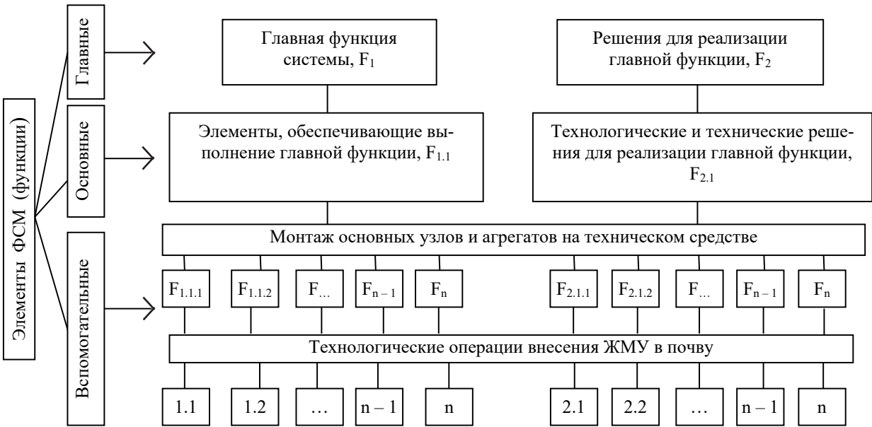
Рис. 2. Методический подход к формированию ФСМ технического средства для внесения в почву ЖМУ Fig. 2. Methodological approach to formation of the FSM of technical means for application of LMF into the soil
