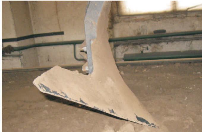
Рис. 2. Лапа посевного комплекса «Кузбасс» с налипшей почвой
