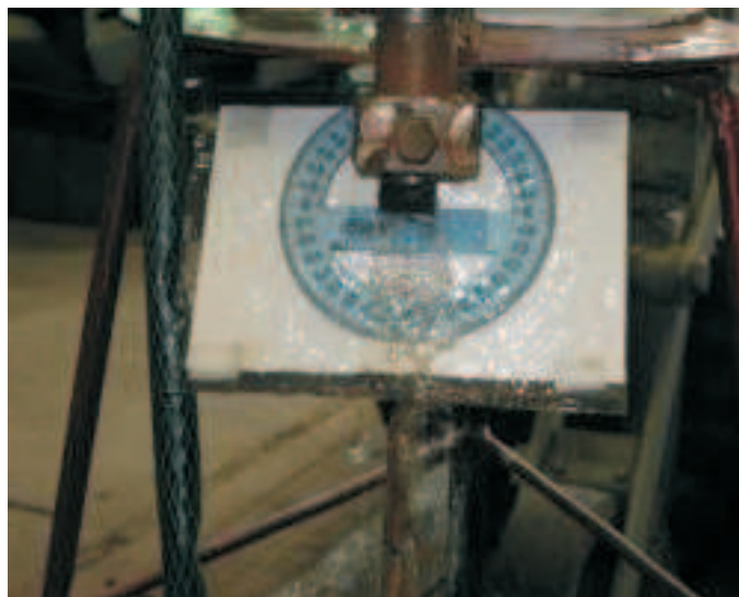
Рис. 4. Экспериментальная установка для определения корневого угла факела распыления рабочей жидкости
