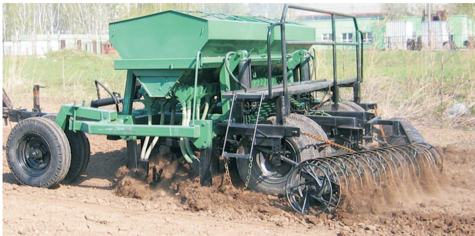
Рис. 1. Почвообрабатывающий посевной агрегат на базе культиватора "Лидер-4"
