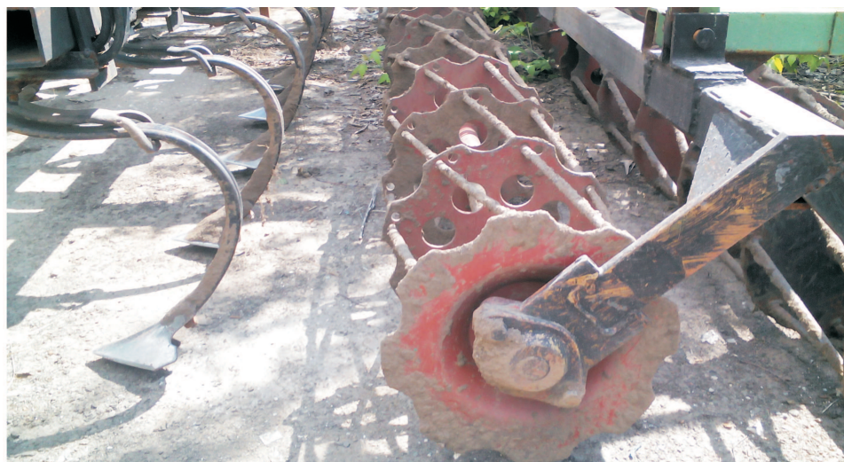
Рис. 2. Рабочие органы культиватора КСО-3
