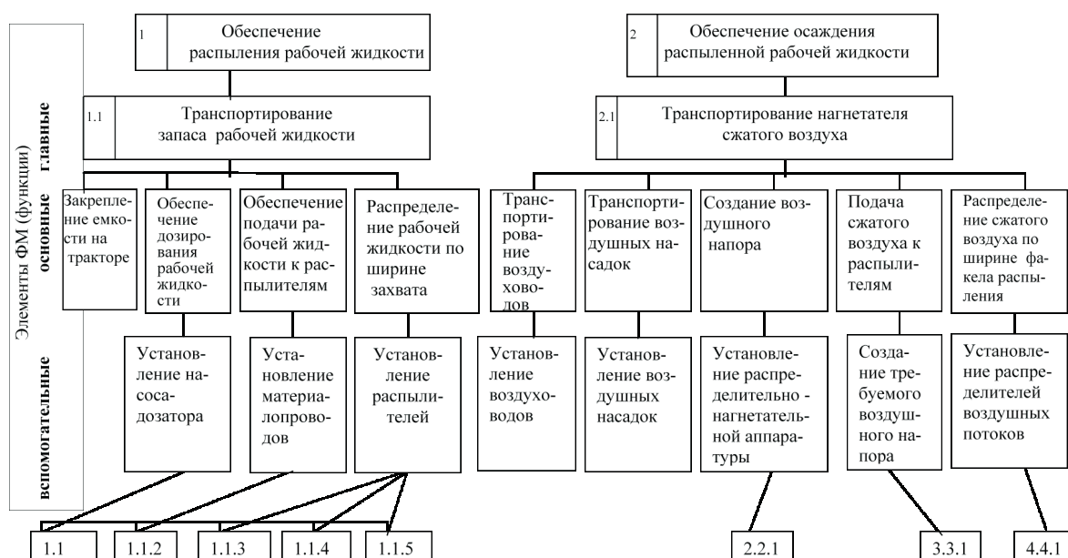
Рис. 3. Функционально-структурная модель технического средства для защиты сельскохозяйственных культур:
