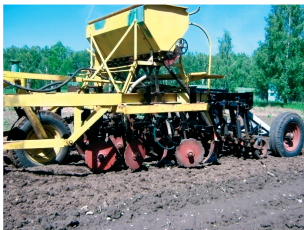
Рис. 6. Экспериментальный образец технического средства с дисково-анкерными сошниками с острым углом вхождения в почву с разнесенными структурными элементами
