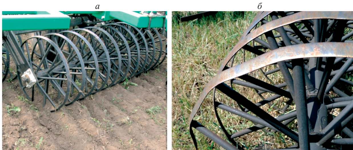
Рис. 1. Батарея рабочих органов кольцевой бороны:
