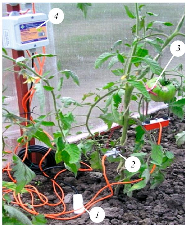
**Рис. 1.** Приборы для измерения параметров растений и внешней среды обитания: 1 – почвенный датчик, 2 – датчик прироста диаметра стебля, 3 – датчик диаметра плода, 4 – радиомодуль
