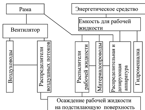
Рис. 2. Структурная схема технического средства для защиты сельскохозяйственных культур
