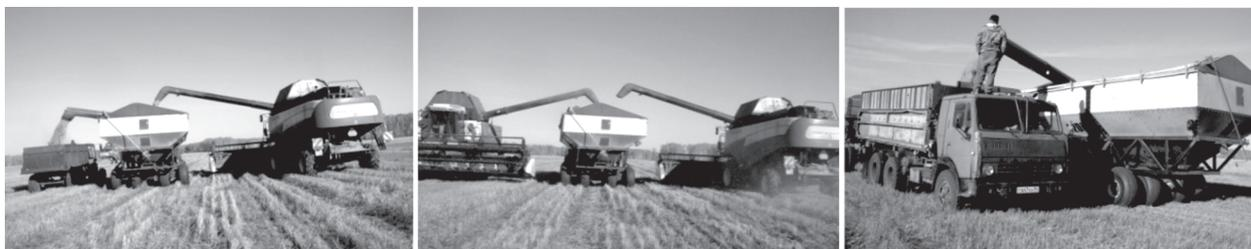
Рис. 3. Транспортное обслуживание комбайнов с применением большегрузного прицепа-перегрузателя
