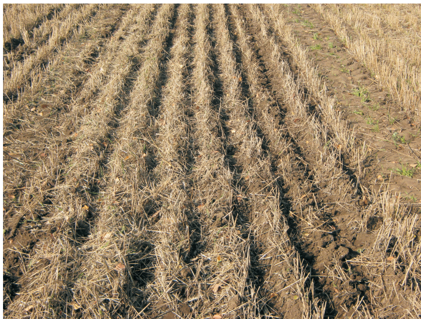
Рис. 7. Вид поля после прохождения экспериментального образца технического средства с дисково-анкерными сошниками с острым углом вхождения в почву с разнесенными структурными элементами
