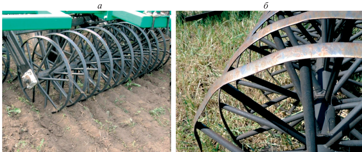
Рис. 1. Батарея рабочих органов кольцевой бороны:
