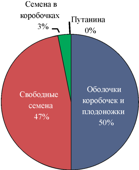
Рис. 4. Фракционный состав вымолоченного вороха при обмолоте ленты льна-долгунца между вальцами лабораторного образца трехвального молотильного устройства (при полноте вымолота семян 100% при P = 3600 шт./пог.м; N = 16 кН; V_{\pi} = 0,4 м/с) Fig. 4. Fractional composition of the threshed heap when threshing a flax stem band between the rolls of the laboratory sample of a three-roll threshing device (when the seed is 100% threshed at P = 3600 pcs/r.m.; N = 16 kN; V_{\pi} = 0.4 m/s)
