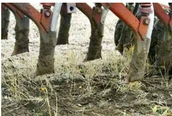
Рис. 1. Вид исследуемых анкерных и лаповых типов сошников
