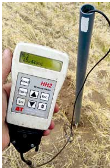
Рис. 2. Электронный влагомер почвы НН-2 Delta-T Devices
