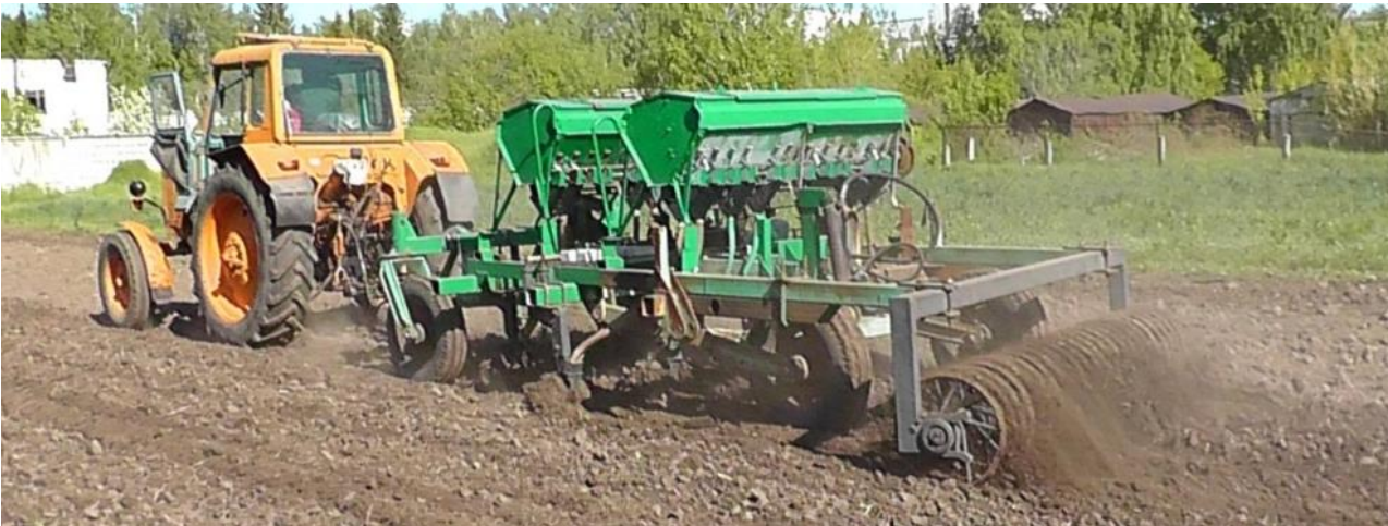
Рис. 6. Посев пшеницы посевной машиной ППМ-2,53Т на опытном поле Fig. 6. Sowing wheat with the PPM-2.5ZT seeding machine on an experimental field
